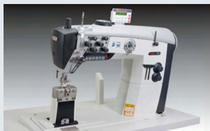
PFAFF 2595/2596 – Ein- und Zweinadel-Doppel-stepstich-Säulenmaschine mit Unter-, alternierendem Ober- und Nadeltransport
